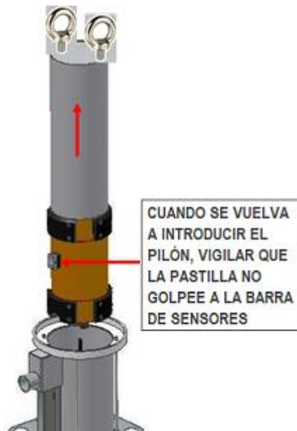
Fig.23. EXTRACCIÓN DE LA PILONA
