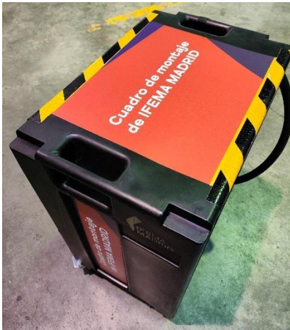
Parte superior de la envolvente del cuadro con asas y vinilo de IFEMA
