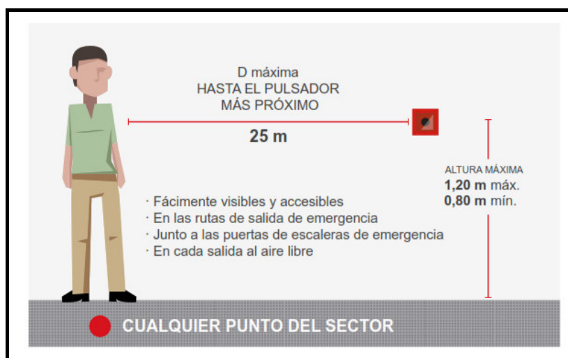
Esquema ubicación Pulsador de Alarma de Incendio
